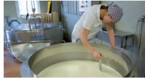
Die Bruchkonsistenz wird geprüft.
