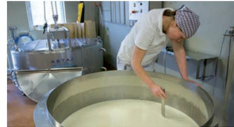
Die Bruchkonsistenz wird geprüft.
