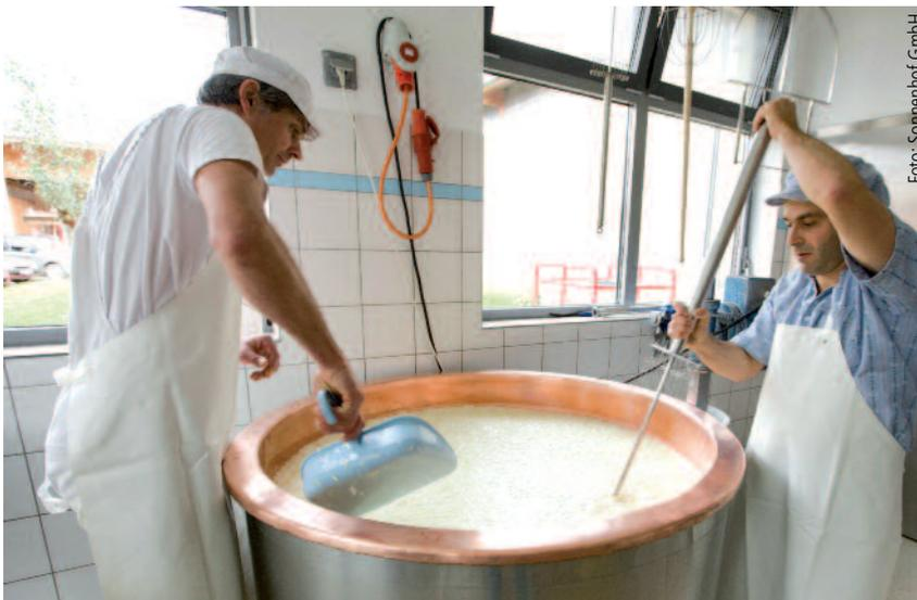
Hier siehst du, wie die Gallerte mit der Harfe geschnitten und mit der „Schuffe“ (das ist das hellblaue Arbeitsgerät auf dem Bild) umgerührt wird. Dabei entsteht der Bruch. Je nach Käsesorte, die hergestellt wird, schneiden die Käserin oder der Käser den Bruch in größere oder kleinere Teile.
