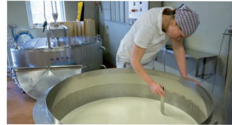
Die Bruchkonsistenz wird geprüft.
